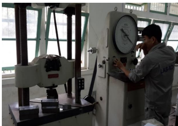
Рис. 5. Определение прочности образцов на сжатие
