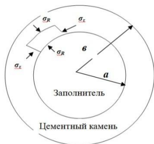
Рис. 1. Схема деформаций цементного камня при усадке:
