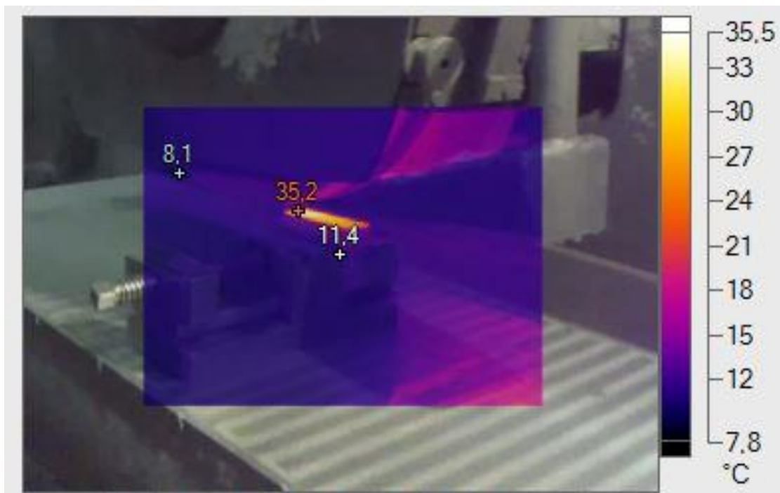
Рис. 2. Диаграмма температурных полей при шлифовании металлополимера WeidlingC
